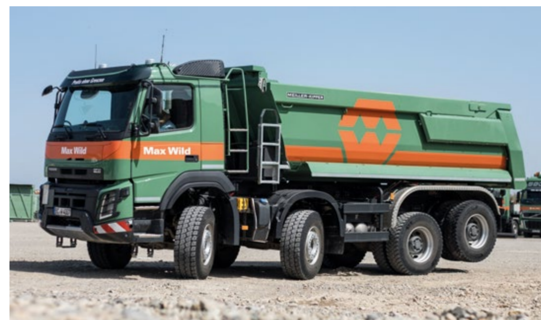
Lkw mit Liftachse und neuer Beschriftung
