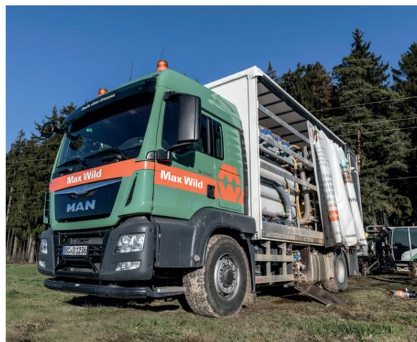
Hohe Geländegängigkeit durch zuschaltbaren hydrostatischen Vorderachs Antrieb
