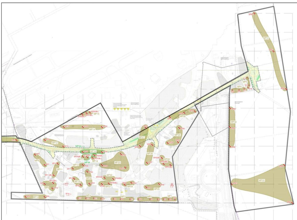
Abbildung 5: Lageplan der Sondieransatzpunkte und Schürfen, Entnahmebereiche der Bodenmischproben
