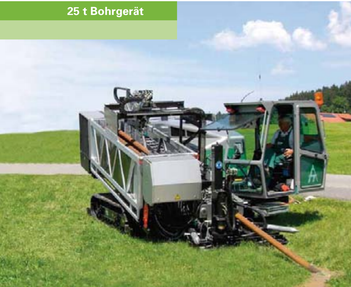
25-Tonnen-Bohrgerät mit einem Standard-Gestängemagazin von ca. 300 Metern
