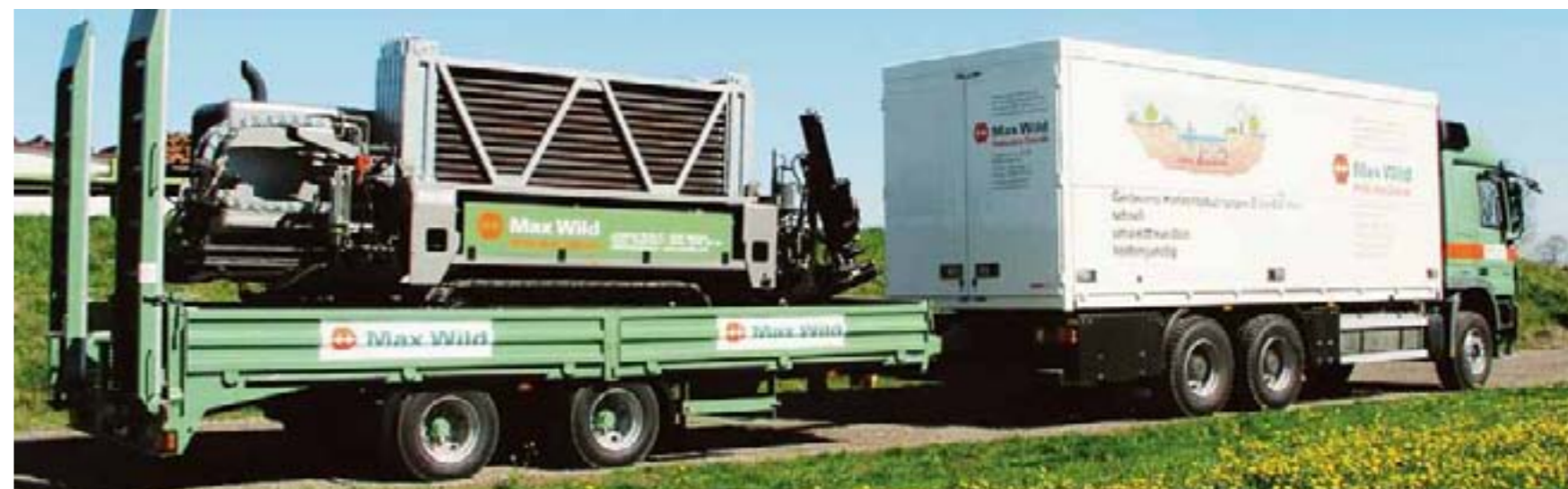
Voll ausgerüsteter Bohr-Lkw mit Bohranlage
