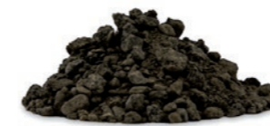
RC-Asphalt 0/22 (in Anlehnung an QRB BaWü und QUBA By ) Deckschicht (Wegebau)
