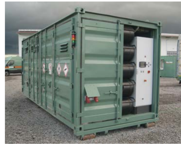
Abbildung: Thermische Aufbereitung für stark belasteten Bohrschlamm
