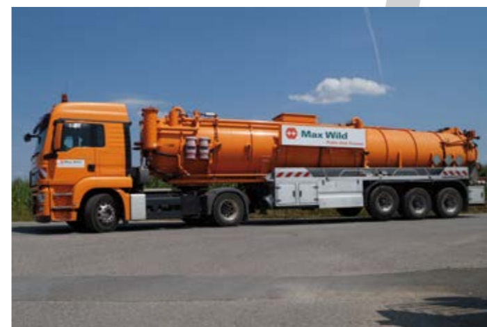
5. Rücktransport recycelter Bohrspülung auf die Baustelle
