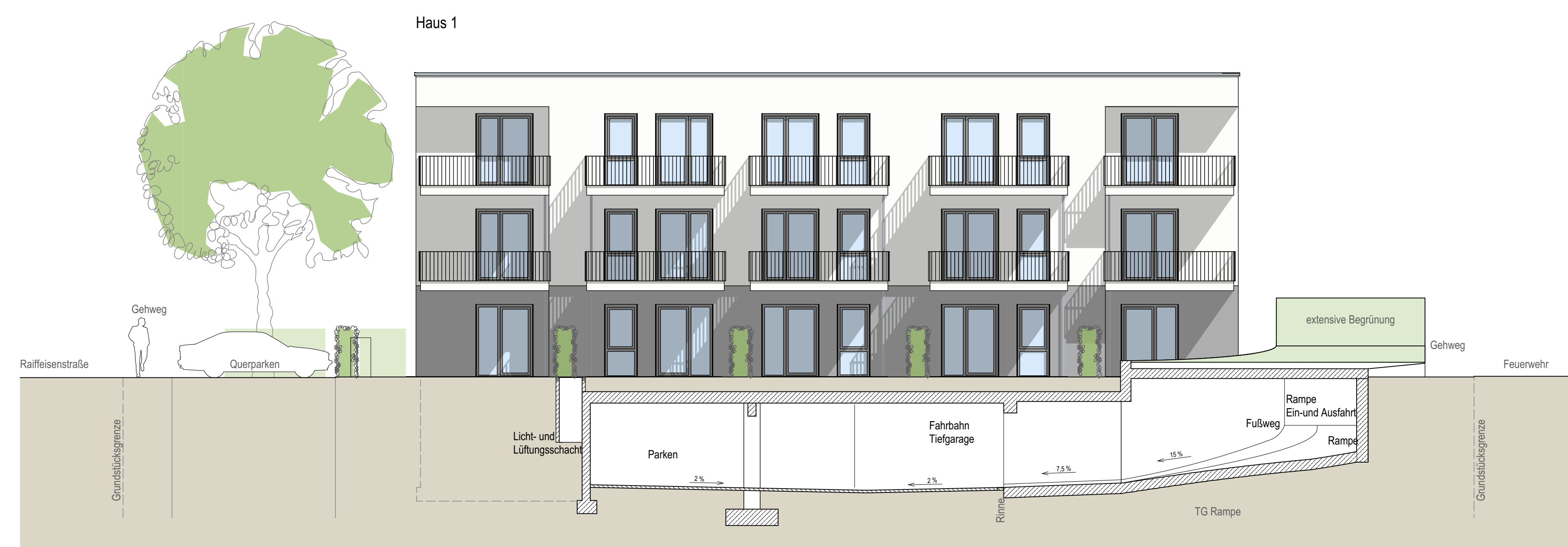
Schnitt 2-2 Tiefgarage Rampe und Haus 1 Ansicht Süd
